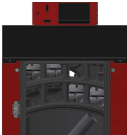
Abbildung 9 Platzierung der Stahlwolle in den Rauchgaskanälen diagonal
