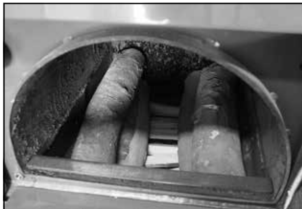
Vier größere Scheite auf beide Seiten der Nachlegekammer einlegen (2 + 2 Scheite)
