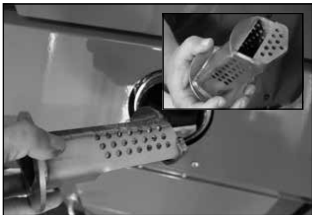
Die Zünd- und Blindkammer herausnehmen
